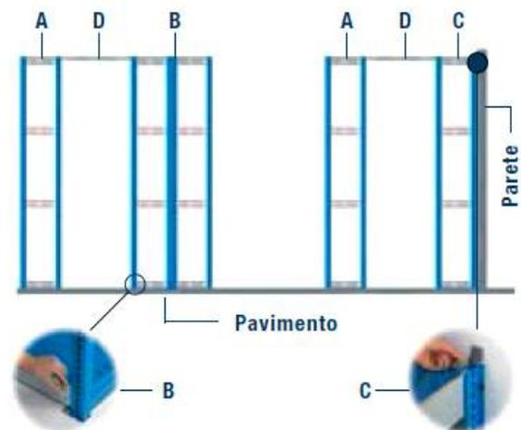
Attenzione: il traversino di collegamento serve per le fiancate con l'obbligo di fissaggio alla parete ma che non hanno la possibilità di essere fissate alla parete stessa. In questo caso la fiancata in oggetto dovrà essere collegata ad una fiancata doppia con fissaggio a terra oppure ad una fiancata fissata a parete.
