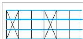
■ È obbligatorio almeno ogni 3 campate utilizzare una campata con crociera o con parete posteriore (sono escluse le campate con fissaggio a parete)
