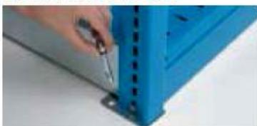
Per il fissaggio a pavimento è obbligatorio utilizzare un tassello per ogni piedino con un valore di trazione (compreso il coefficiente di sicurezza) di **4,3 Kn**.
