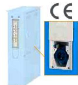
Gli armadi per allacciamenti vengono forniti di serie con una porta laterale completa di serratura a cilindro con due chiavi. In questo armadio può essere montato un impianto elettrico e/o un impianto pneumatico. La scatola porta prese viene inoltre fornita di serie con un magnetotermico 2P 230V AC 10A e collegata (tramite una robusta guaina) a una presa industriale posteriore piatta con chiusura a ghigliottina 220-240V 16A 2P+T. Grado di protezione dell'impianto IP30.
