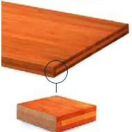
Sono costruiti in tre strati di faggio incrociati tra loro e formano una superficie liscia che viene trattata con materiale antisettico. I listelli che formano i tre strati, si accostano tra loro mediante fresatura dentellata per garantire una maggiore tenuta.
