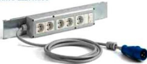
L'impianto elettrico (con grado di protezione **IP 30**) viene fornito di serie con un interruttore magnetotermico 230V 10A, 5 prese 220-250V 10A 2P+T e 1 spina industriale 220-250V 16A 2P+T.
